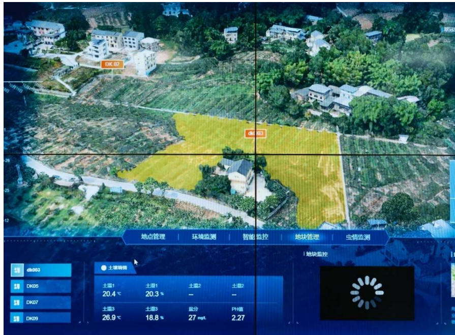
图 2-19 重庆市雾江区双林镇，镇政府内的“智慧梨园”系统监控屏幕。相关负责人在 2022 年通过航空测绘技术完成双林镇的建模，同时在不同区域安装监测设备，对具体梨园安装气象、土壤与病虫害监控，数据经过后台处理，能直接在屏幕上显示对应地块的具体信息。
