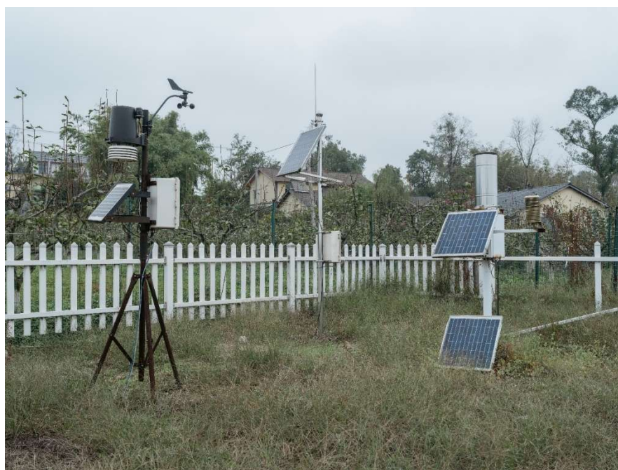
图 2-18 双林镇梨园内的监测设备，村集体与农业公司都加强了对天气、虫害与土壤的检测，希望及时应对可能的风险。这些设备价值不菲，实时监测到的数据被传输到后台终端进行分析，农业专家与 AI 根据数据对梨树的养护种植提供建议。
