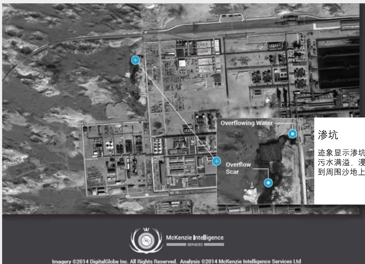
图 7：渗坑中积水满溢到周围沙地上，2014 年 3 月 20 日
